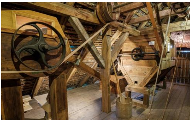
[3] Sechskant-Sichter und Elevatorenantrieb, 2. Mahlboden
