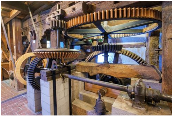
[1] Die Antriebsebene mit Zahnradtechnik und Elevatoren
